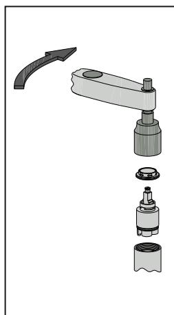
[ **D** ] - Die Mutter mit einem Schlüssel, 27 mm (32 mm für den UP - Einhebelmischer) ausschrauben und die Kartusche abnehmen.
