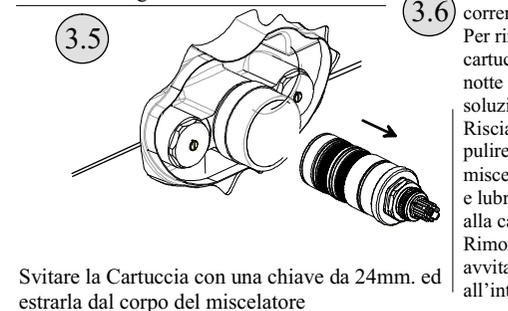
3.6 Pulire i filtri sotto l'acqua corrente. Per rimuovere il calcare dalla cartuccia immergerla per una notte nell'aceto o in una soluzione anticalcare. Risciacquare bene la cartuccia, pulire l'interno del corpo del miscelatore con un panno umido e lubrificare gli O-rings intorno alla cartuccia. Rimontare la cartuccia avvitandola in senso orario all'interno del corpo.
